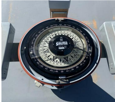
Gambar 3.3 Kompas yang digunakan untuk Mengetahui Haluan Sejati Kapal di Kapal PELNI 119.KM-Kelud.
