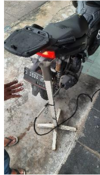
Gambar 3. Proses pemasangan selang Uji Emisi kedalam Knalpot Kendaraan
