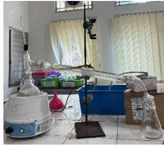
Proses Destilasi Etanol 96%
