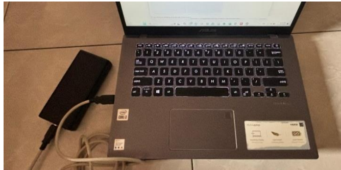
Gambar 3. 3 SQM LU - DL yang Dihubungkan Dengan Laptop
