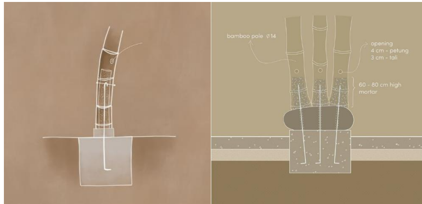
Gambar 59 Proses pembuatan pondasi foot plate kolom bambu (sumber:pablolunastudio.com)
