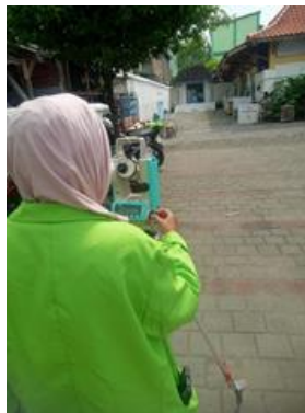
Gambar 3.7 : Menentukan Arah Kiblat menggunakan Theodolite
