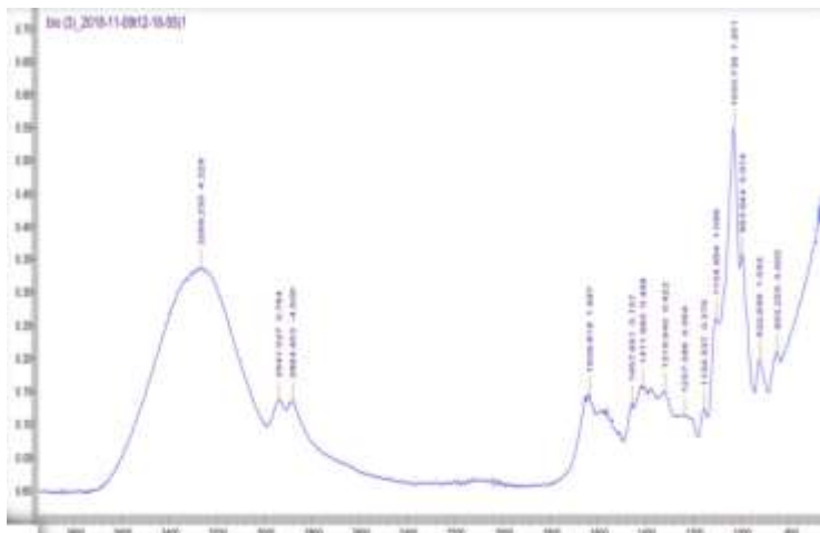
Gambar 2.10 Hasil FT-IR Bioplastik Selulosa-Kitosan-Gliserol (Yustinah et al. , 2023)
