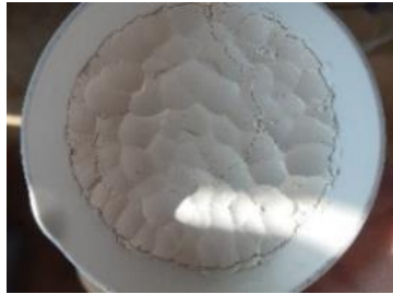
Gambar 4.1 Hasil Kalsinasi Kaolin Menjadi Metakaolin
