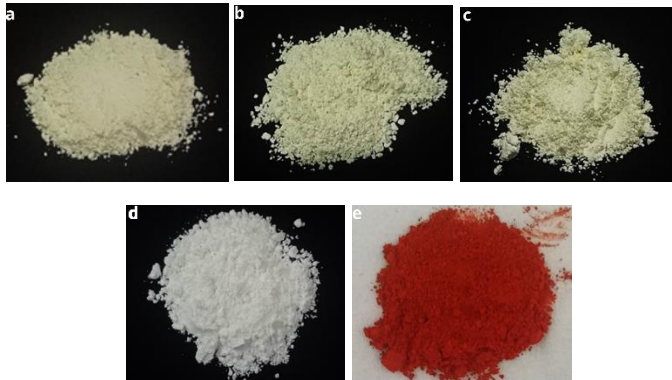
Gambar 4.1 Hasil Sintesis (a) BiOI/ZnO, (b) BiOI/ZnO 100 (c) BiOI/ZnO 300, (d) ZnO, dan (e) BiOI
