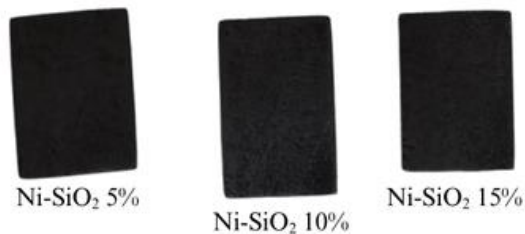
Gambar 4. 10. Logam Besi Setelah Dilapisi \text{Ni-SiO}_2
