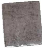
Gambar 4. 8. Logam Besi Sebelum Dilapisi Gel Silika
