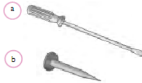
Gambar 2.11. Prinsip baji digunakan pada (a) obeng dan (b) paku
