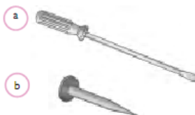
Gambar 2.11. Prinsip baji digunakan pada (a) obeng dan (b) paku 24
