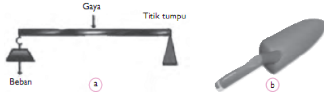
Gambar 2.5. a) Tuas golongan ketiga. dan b) sekop. 16
