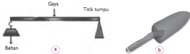
Gambar 2.5. a) Tuas golongan ketiga. dan b) sekop.
