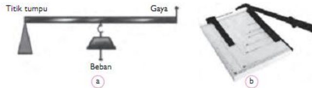
Gambar 2.4. a) Tuas golongan kedua dan b) pemotong kertas.
